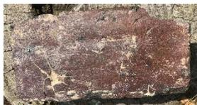
Direkt über den Feuerungen sind die Steine am stärksten durchgebacken. Dort sintern die Ziegel oft zu Schmelzklumpen zusammen. Diese können dann jedoch immer noch für Wasserbauten oder die Pflasterung von Wegen und Ställen genutzt werden.
